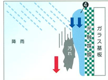
④十分な雨水により、水膜は、汚れを浮かせながら、水膜が下方へ流れ落ちる力によって、汚れを洗い落とします。
