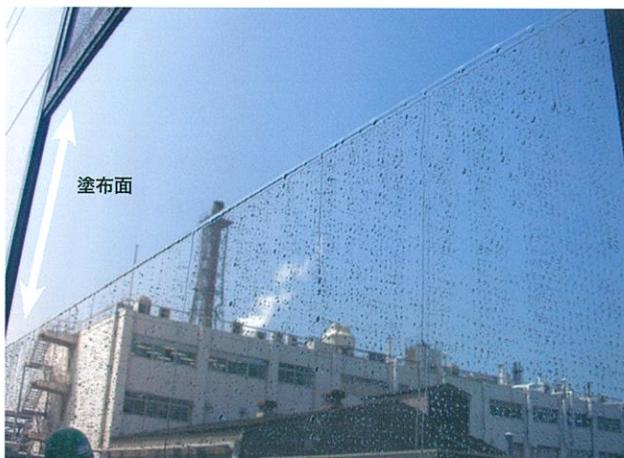
未塗布面では水滴による乱反射が発生、塗布面では薄い水膜となるため、乱反射が抑えられ、視界が確保されます。
