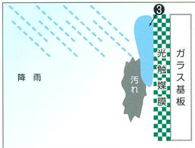
③汚れの付着力が弱まっているところへ、雨が降ると、雨水は、水になじみやすくなっている光触媒膜表面で厚い水膜となり、徐々に、汚れと光触媒膜との界面にもぐりこんでゆきます。
